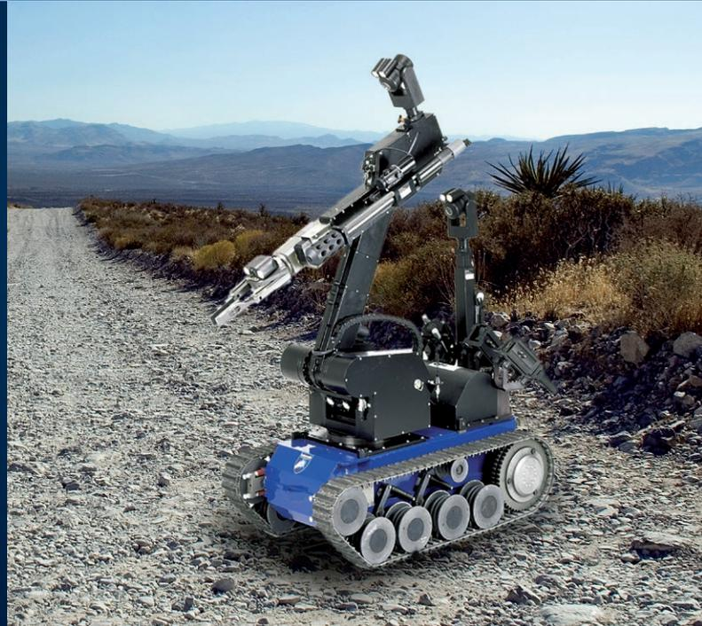
Exemples d'application: Tête de caméra panoramique · Véhicule manipulateur autonome
