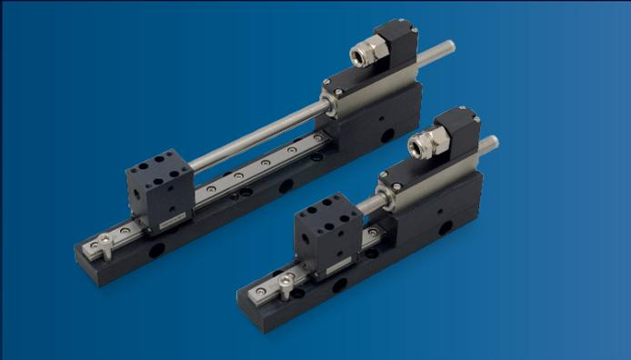
Les servomoteurs linéaires offrent de nouvelles possibilités d'intégration pour les mouvements linéaires. Ces entraînements linéaires puissants et compacts consistent en un stator fixe avec une bobine à 3 phases et un tube de précision contenant des aimants permanents.
