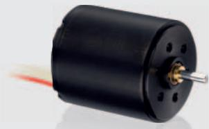
IEH3-4096系列集成编码器在IEH2的单芯片结构基础上发展而来。由于耐热性能佳，IEH3的工作温度范围可以扩展到-40至+100摄氏度。与带有单独的安装外壳、从而需要很大空间的编码器不同，IEH3-4096只会给电机增加1.4 mm的长度，并能与FAULHABER SR系列的许多贵金属换向直流微电机（直径在15至22 mm之间）组合使用。新型编码器提供2个方波信号和一个额外的索引通道。它的分辨率高达4096个脉冲，并改善了同步性，特别是在低转速范围内。集成编码器IEH3-4096可用于很多领域：设备技术、测量设备、阀门调整、摄像机技术和精密光学仪器（如反射镜定位、透镜调整、滤光镜校准）。
