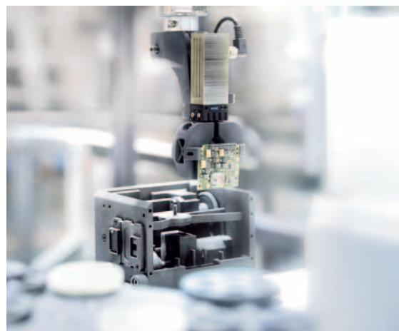
SCHUNK双指电动平行夹持器EGP用于电子元件的精确组装。
